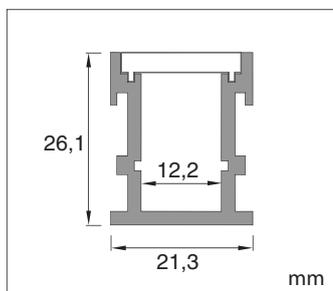
Perfil para empotrar en suelo. Alta profundidad para mayor uniformidad de la luz. Difusor de PC reforzado de 3mm. Para tiras de LED de hasta 12mm.
